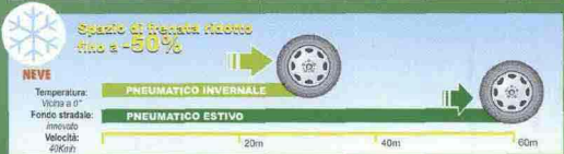
Gli spazi di arresto fanno riferimento ad una vettura di media cilindrata dotata di ABS equipaggiata con pneumatici nuovi
